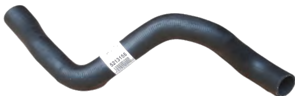
5213155 Ø INT. 34mm Ø INT. ANCHO 39mm RADIADOR INFERIOR
