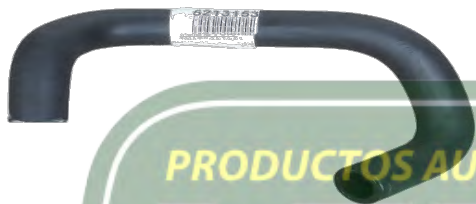
5213153 Ø INT. 19mm DE PASO DE TANQUE DE RECUPERACIÓN
