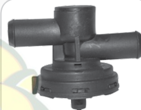
V-65536 Ref.: V-5536 Válvula alimentación calentador Chevy C2 1.6L 4Cil. 01/07, Corsa y Tornado 1.8L No. Original: 93275536
