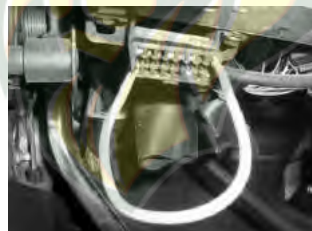
Punteando las terminales del conector DLC
