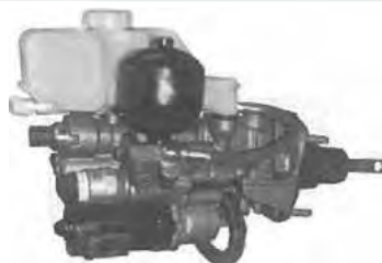
Sistema abierto hidroreforzado
