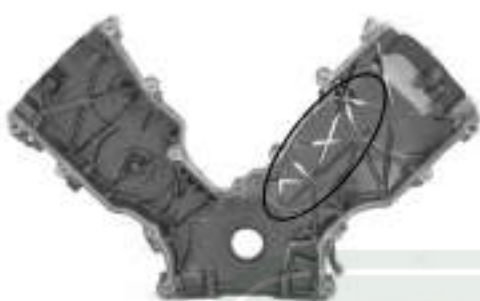
Desgaste por fricción de los componentes internos. (engranes o cadena de tiempo)
